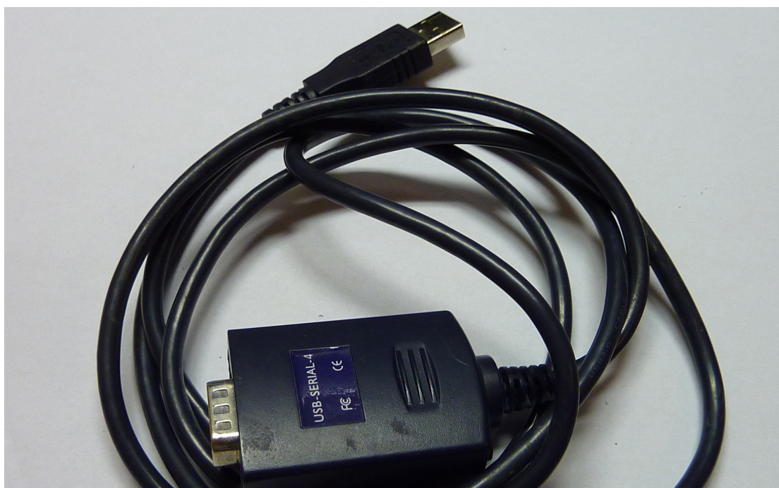
Obr. 11: Reálné foto USB-SERIAL převodníku
